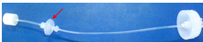
图1-12 更换 ACEA NovoFlow 鞘液预过滤器
