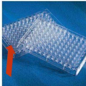
微孔板的光程和加入液体体积成线性相关，一般200微升约0.5cm，参考后续光程校准内容确定
